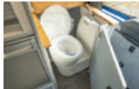
Flushing cassette toilet
